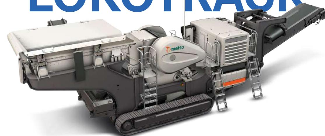
**ДРОБИЛЬНЫЕ УСТАНОВКИ ЛОКОТРАСК СЕРИИ LT** могут работать близко к уступу карьера, благодаря чему оператор экскаватора или колесного погрузчика может контролировать весь процесс дробления, что значительно снижает себестоимость работ и рабочую нагрузку. Использование установок крупного дробления
