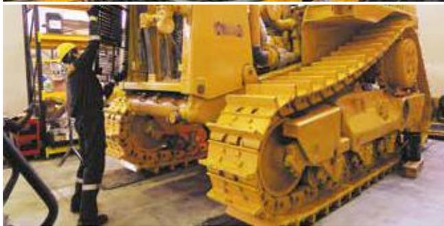
В декабре 2015 года «Восточная Техника» выполнила капитальный ремонт бульдозера D10T с использованием запасных частей Reman. Ремонт получил официальную сертификацию «Cat® Certified Rebuilt».
